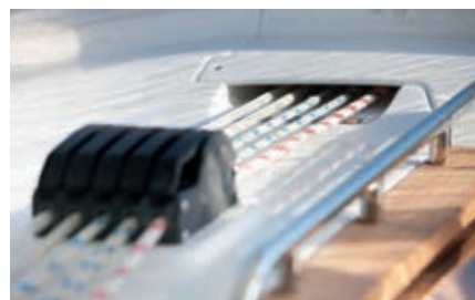
Mindegyik felhúzó kötél áttekinthetően a cockpitba vezetve (CR 40 kép) – az egyszerű és központi kezelésért.
