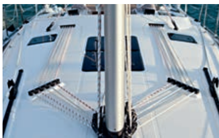
Mindegyik felhúzó kötél áttekinthetően a cockpitba vezetve (CR 40 kép) – az egyszerű és központi kezelésért.
