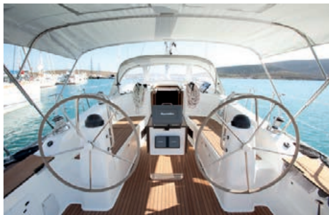
Dupla kormány (CR 55, 50, 45 és 40): a magas sprayhood* és a nagyméretű-bimini* igazán nagy védelmet biztosít a szél és eső ellen.
