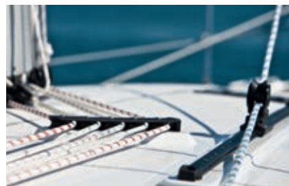
A felépítményen elhelyezkedő genuakocsik nem csak a fedélzet rendezettségéről gondoskodnak, hanem a vitorlák állításáért is felelősek.
