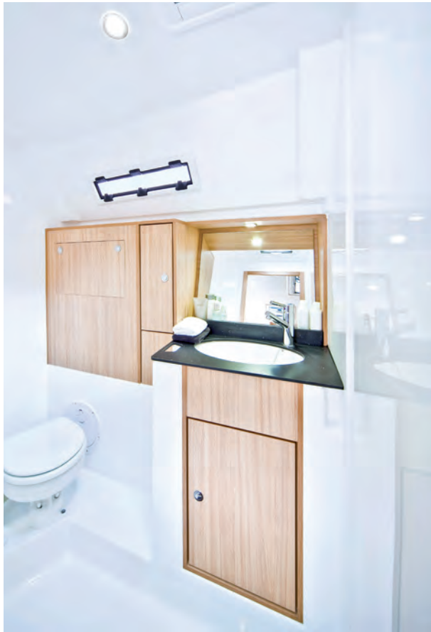
Backbord: Nasszelle mit Duschtrennung zum Waschtisch. Port side: Wetroom with shower separation to washbasin.
