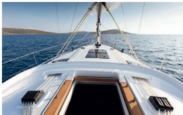
BAVARIA dupla großschottrendszer a traveller nélküli pontos trimmelésért és biztos fogásért.
