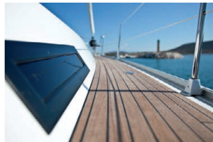
Fedélzet felépítmény: a ferde oldalú felépítmény által több napfény jut a hajó belsejébe, ezzel egyidejűleg szilárdítja fedélzet szerkezetét, FSC-tanúsítvánnyal ellátott fa a fedélzet járófelületén.*
