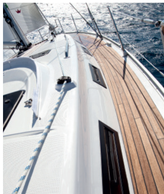
A modern 9/10 rigg széles szállingokkal és kívülre elhelyezett vantnikkal kiváló vitorlázó tulajdonságot, optimális erőátvitelt a hajótestre és szélesebb oldalsó fedélzetet tesz lehetővé.
